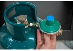
2. Avvitare il regolatore del gas nella valvola della bombola e, a mano, girare in verso antiorario il bullone. Aiutarsi con una chiave apposita per regolatore del gas per il perfetto serraggio e per evitare di danneggiare la guarnizione della valvola compromettendo la tenuta stagna.
