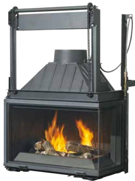
Les inserts contemporains 747-2V sont entièrement en fonte et leur grand retour vitrée permet d'équiper les plus belles cheminées d'angle. Ils existent en 2 versions : porte relevable (PR) et sans relevage (SR). La version relevable permet l'escamotage de la porte pour un nettoyage facile des vitres.
